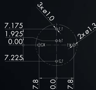
Sicht auf Bestückungsseite der Leiterplatte Kontaktbelegung: sh. Schaltbild der jew. Typen
