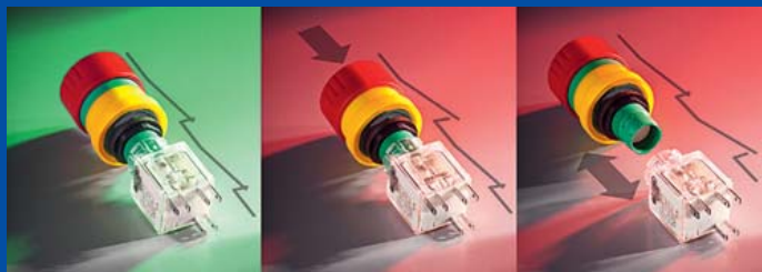
Automatische Abschaltung bei Trennung des Kontaktgebers von der Not-Halt-Taste
