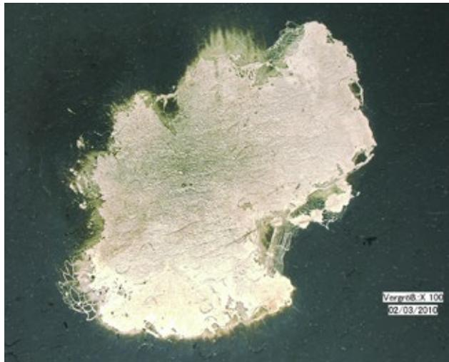
Kommt es zu mehreren Durchschlägen auf kleiner Fläche, besteht die Möglichkeit, dass der **Selbsteileffekt** in seiner Funktion gestört wird. Die Folge kann ein Ausfall des Kondensators sein. Hier kommt der zweite Faktor des Vierfach-Sicherheitssystems zur Geltung, die sogenannte **segmentierte Metallisierung**.
