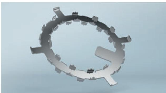
Der Vorteil dieser lötfreien Verbindung: Die Gefahr einer Vorschädigung des Kondensatorwickels durch Überhitzung beim Anlöten der Anschlussdrähte ist völlig ausgeschlossen. Die Qualität des Wickelanschlusses wird durch den Kontakttring signifikant erhöht. Weiterhin unterstützt und verbessert er durch die dauerhaft feste Punktschweißverbindung die Zuverlässigkeit der Überdruck-Abreißsicherung.
