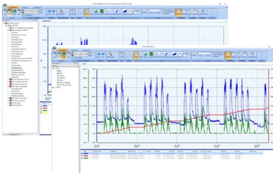
Im physikalischen Systembaum sind zu jedem Energie-Management Gerät Standardauswertungen hinterlegt, die dem Anwender auch ohne Projektierung die Visualisierung der aufgezeichneten Messdaten ermöglichen.
