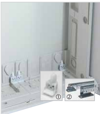
Lieferung ohne Montagerahmen. Je Feldbreite sind 4 Montagefüße ① enthalten, auf denen die Senkrechtprofile ② für die Montage von VPS Funktionen befestigt werden. Die Montagefüße können in zwei Positionen im Schrank eingesetzt werden, standardmäßig erfolgt der Aufbau auf der hinteren Position.
