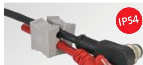
Teilbare Mehrfach-Kabeltüllen, Sondertüllen Schutzart IP54 und UL Type 12 Leitungsdurchmesser 1 bis 8 mm KT multi 72
