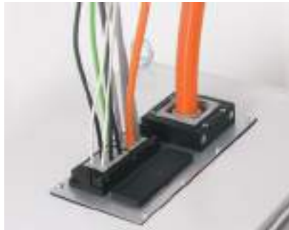
Kabeinführung mit Modulplatten durch das geschlossene Schaltschrankdach. Ausbruchgröße 314 x 144 mm
