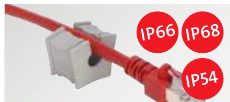
Teilbare Einfach-Kabeltüllen Schutzart bis zu IP66/IP68 und UL Type 4X Leitungsdurchmesser 1 bis 35 mm KT 68 – 69
