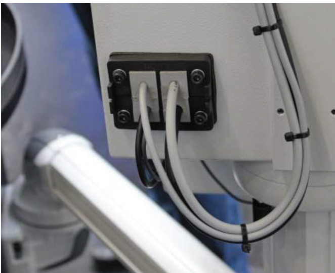
KEL-QUICK-B4 - Seite 50 Einführung von konfektionierten elektrischen Leitungen in ein Bedienpanel
