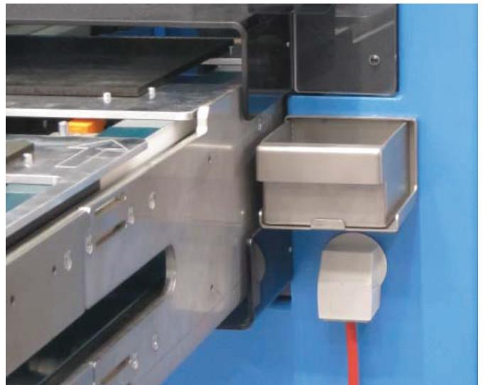
KVT 50-W90 - Seite 42 Teilbare Winkelverschraubung zur Einführung einer konfektionierten Leitung des Bedienpanels.
