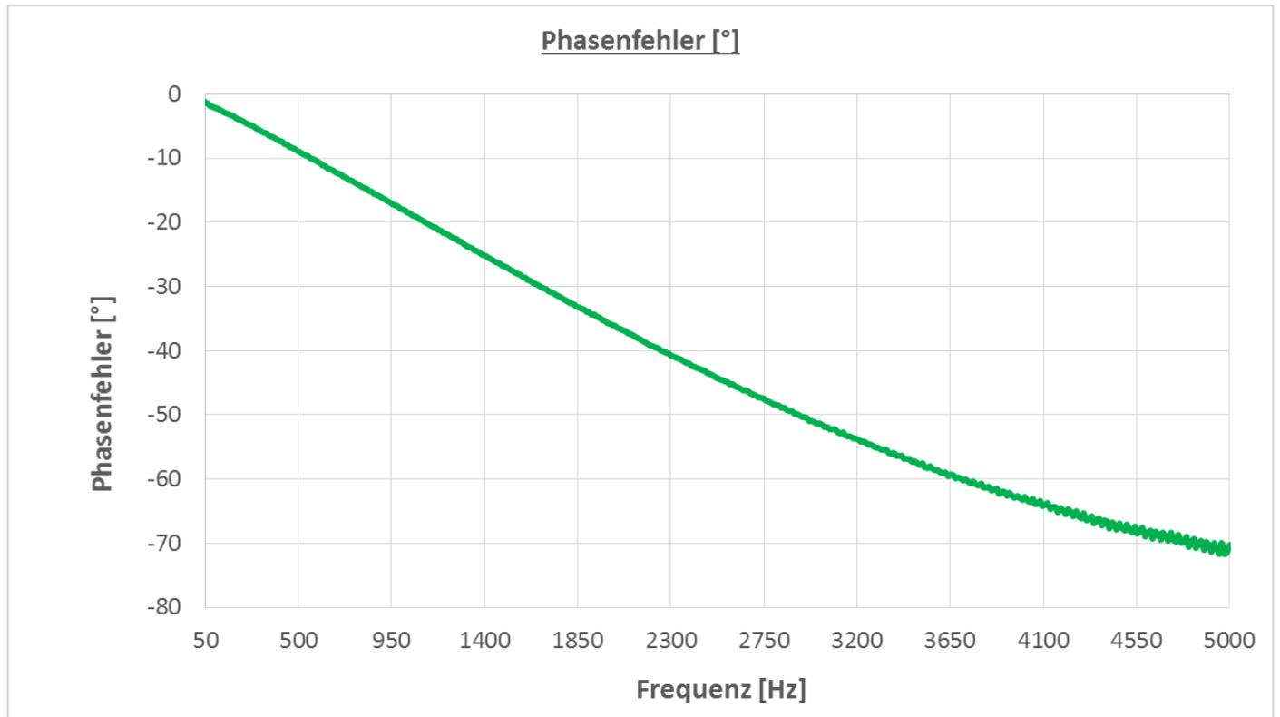
Abbildung 11: Frequenzübertragungsverhalten des ROI-3 mit einer FASK 150 (Amplitudenfehler und Phasenfehler)
