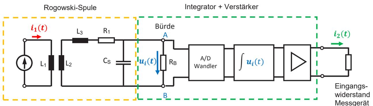
Abbildung 3: Elektrisches Ersatzschaltbild Rogowski-Spule + 1 A Integrator
