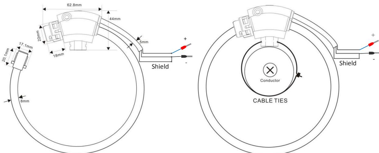
Abbildung 7: Anschlüsse und weitere Abmessungen der FASK 100, 150, 200 und 300
