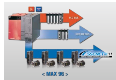
Die MELSEC System Q sorgt für Ausgewogenheit zwischen Steuerung und Motion-Control.
