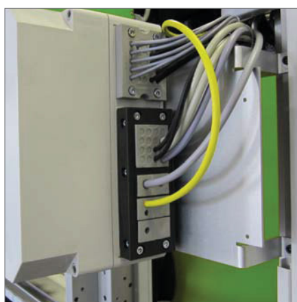
KEL-DPZ B25 Seite 64 / KEL 24|7 Seite 16 Kombination von teilbaren Systemen und Durchstecksystemen zur Einführung von Leitungen in einen in die Maschine integrierten Schaltschrank.
