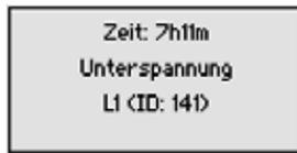
Die Alarmhistorie zeigt die letzten 10 Alarmer an. Hierbei steht der neuste Alarm an erster und der älteste Alarm an letzter Stelle (zeitlich sortiert). Die angezeigten Alarmer können durch Markieren der entsprechenden Zeile und Betätigen der [i]-Taste in Klartext angezeigt werden.
