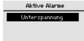
Die Grenzwerte einiger Alarmer können in dem Menü Parametrierung eingestellt werden (siehe *Abschnitt 6.3.2 „Alarmer“*). Alle Alarmer sind in *Abschnitt 9 „Fehlerbehebung“* gelistet.
