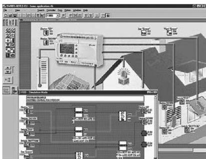
Alle Steuerungen der ALPHA-Familie können mit dieser Windows-Software programmiert werden. Sie ist sehr leicht zu handhaben, es sind keine speziellen Vorkenntnisse des Anwenders erforderlich. Bei der Programmierung werden
