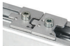
SC Fuß, Schraubfuß lose, für C-Schiene (16 – 17 mm Öffnungsmaß), mit Verdrehsicherung VE: 10, Art.-Nr. 36231
