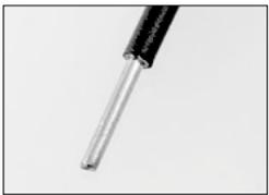
Isolierung des Drahtes auf eine bestimmte Länge abtrennen.
