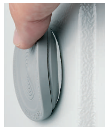
Die einzelnen Ringe werden je nach benötigtem Durchmesser der einzuführenden Leitung abgeschält. Hierzu wird lediglich ein kleines Loch zwischen den Ringen gestochen. Anschließend kann der entsprechende Ring abgezogen werden.
