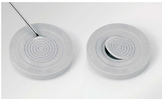
Die einzelnen Ringe werden je nach benötigtem Durchmesser der einzuführenden Leitung abgeschält. Hierzu wird lediglich ein kleines Loch zwischen den Ringen gestochen. Anschließend kann der entsprechende Ring abgezogen werden.
