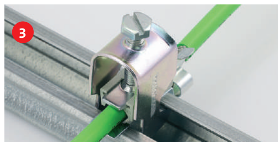
Einfache Montage: 1. Schirmklammer auf C-Schiene befestigen 2. Kabel in der Schirmklammer einrasten 3. Bügelschelle montieren
